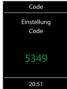
Den PIN-Code für den Service-Bereich eingeben.
